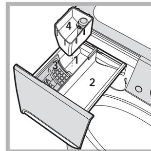
Această funcție este utilă pentru a elimina petele rezistente. Introduceți sertarul adițional 4, din dotare, în sertarul 1. La dozarea decolorantului, nu depășiți nivelul "max" indicat pe pivotul central (a se vedea figura). Pentru a efectua numai albirea turnați decolorantul în
